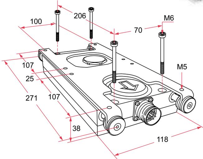
Transportador eléctrico lineal patentado con tecnología inteligente y sin necesidad de mantenimiento. Fabricado en acero de alta resistencia, aluminio anodizado, **IP62**, serie **BLACK LINE**, para la mayoría de las industrias de fabricación, y fabricado en acero inoxidable, aluminio anodizado **IP66**, serie **CLEAN LINE**, a prueba de polvo y salpicaduras, idoneo para el sector farmacéutico o alimentario.
